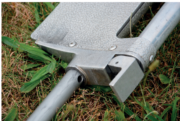
Obr. č. 5/76 Před použitím je nutné správně určit délku SCOOP rámu
