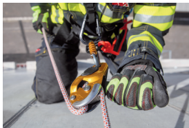
Obr. 7 Rychlost slánění vždy reguluje pouze ruka svírající lano, nikoli páka slaňovacího prostředku
