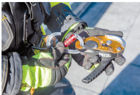
Obr. 5a-b Karabina, ve které je připojen slaňovací prostředek, musí být při zatížení západkou a pojistkou zámku karabiny směrem k tělu slaňujícího hasiče
