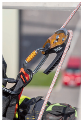
Obr. 5a-b Karabina, ve které je připojen slaňovací prostředek, musí být při zatížení západkou a pojistkou zámku karabiny směrem k tělu slaňujícího hasiče
