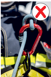
Obr. 6c Chybná poloha karabiny
