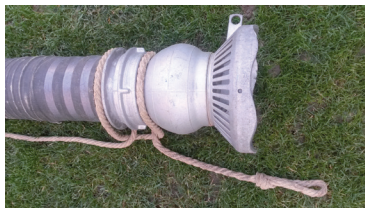
Obr. 2 Úvaz přívodního vedení
