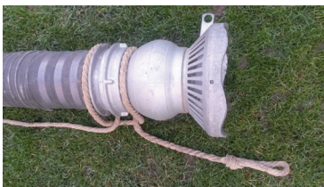
Obr. 2 Úvaz přívodního vedení
